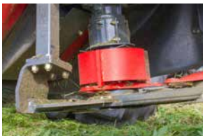
Direktantrieb vom Getriebe zur ersten Scheibe für effiziente Kraftübertragung.
