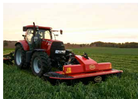
Durch Wechseln der Riemenscheiben kann mit 750 U/min gefahren werden. Dies spart Kraftstoff.
