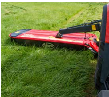
Die Boden Anpassung kann in einem Winkel von 15° nach oben bzw. unten erfolgen.
